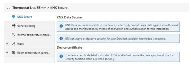
Fig.5.1 (1) "KNX Secure" parameter window
