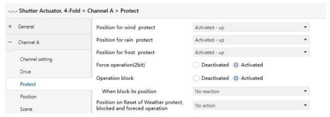
Fig.5.5 parameter window "Protect"
