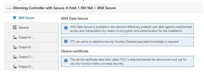
Fig. 5.1 (1) "KNX Secure" parameter window
